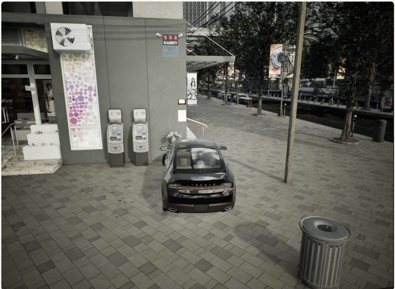
Fahrszenario der SIL-Umgebung – Basis für OpenSCENARIO-Replay und HiL/SiL-Validierung.
